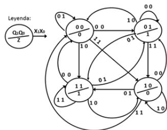
b)  $J_1 = X_0 \cdot Q_0 + X_1 \cdot \bar{Q}_0$        $K_1 = \bar{X}_1 \cdot \bar{X}_0 + \bar{X}_1 \cdot Q_0 + X_1 \cdot X_0 \cdot \bar{Q}_0$
